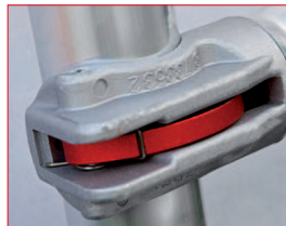
Gepresste Verbindung zwischen Klaue und Strebenrohr, Einrastklauen mit Farberkennung an Streben (rot = horizontal, schwarz = diagonal)
