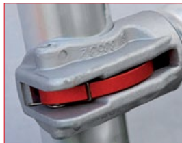
Čvrsta veza između spojnice i cijevi. Spojnice s obojenim zaticima (crvena = vodoravno, crna = dijagonalno)
