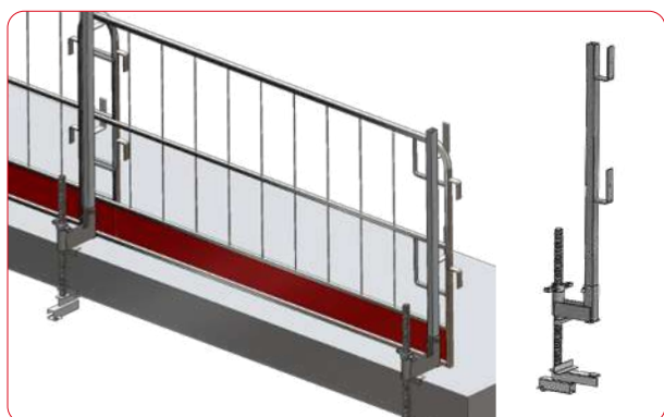
- S univerzalnom spojnicom za zaštitnu ogradu na rubu stropa - Raspon podešavanja 50-450 mm
