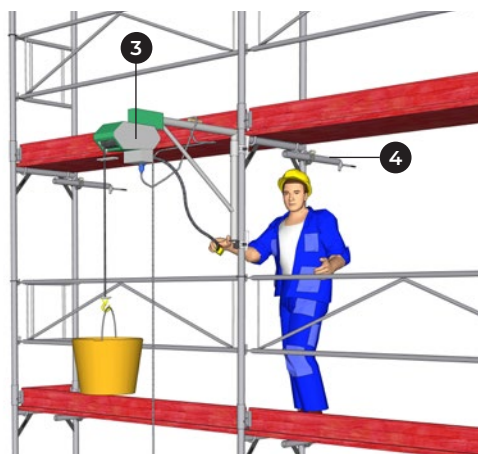
Montaža s električnim vitlom
