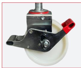
Die Doppelbremslenkrollen haben einen Durchmesser von 200 mm und sind unter Belastung leicht zu entriegeln. Sie können 25 cm ausgespindelt werden.
