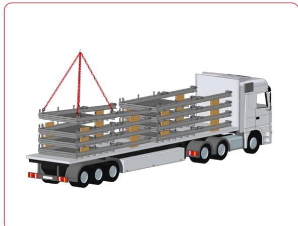
Die Bühnen werden mittels LKW angeliefert. Die jeweils oberste Bühne wird zur Vorbereitung vom LKW gehoben und auf einer ebenen Fläche abgelegt.
