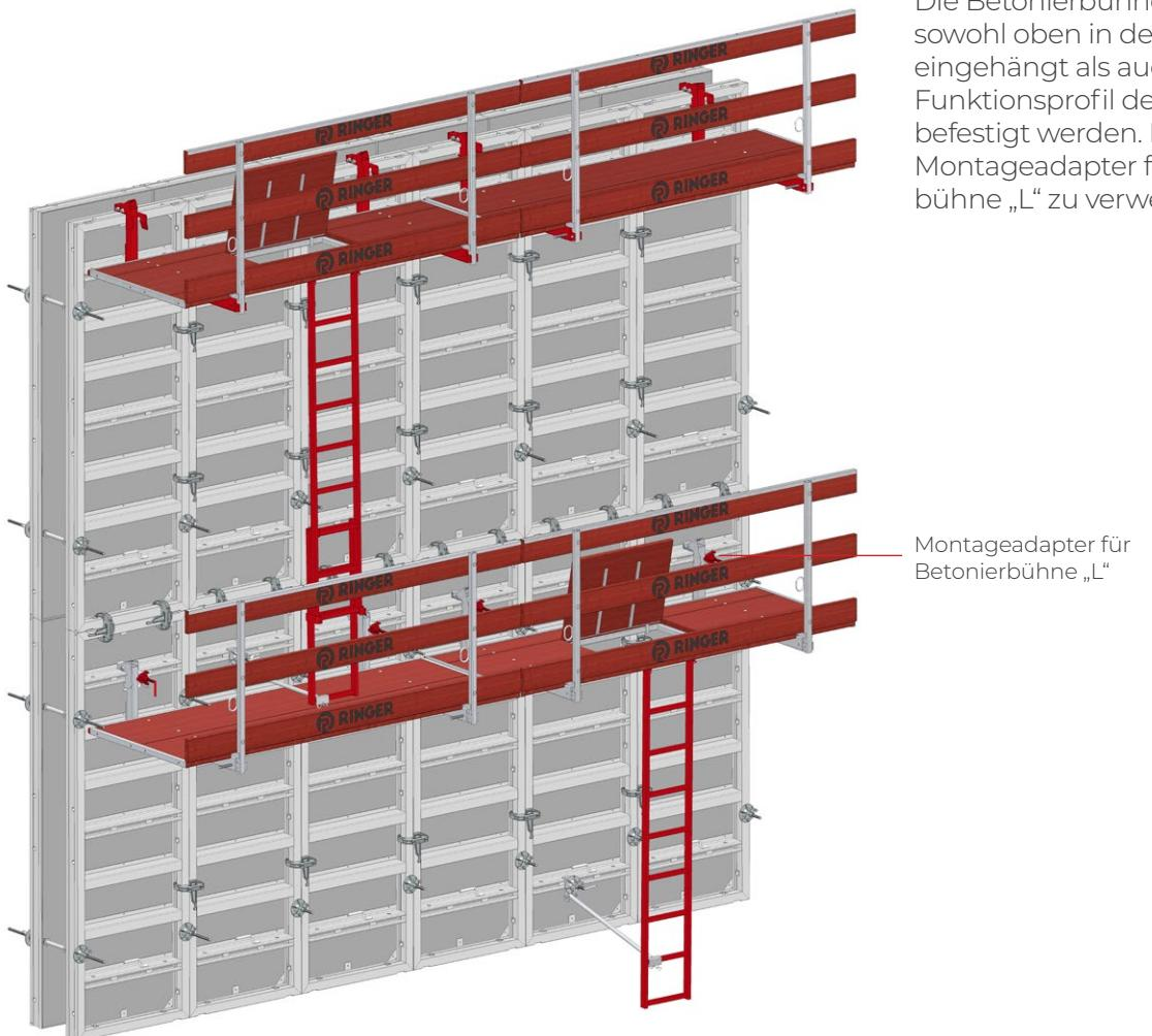
Die Betonierbühne „L“ kann sowohl oben in der Schalung eingehängt als auch im Funktionsprofil der Schalung befestigt werden. Dazu ist der Montageadapter für Betonierbühne „L“ zu verwenden.
