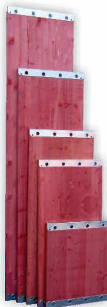
Podlahy RINGER - pozinkované konce desek s odvětráním čel lamel - lepené lamely o síle 35mm - nosnost: 200 kg/m 2 - odpovídá normě EN 12801-2 - standardní rozměr: 2,50 x 0,60 m - možná provedení také: 3,00 / 2,00 / 1,50 / 1,25 / 0,72 x 0,60 m
