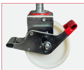
Vrtljiva kolesa z dvojno zavoro imajo premer 200 mm in se enostavno odklenejo pod obremenitvijo. Lahko se izvlečejo do 25 cm.
