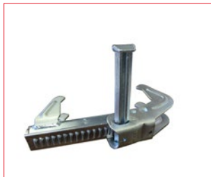
Master izravnalna spojka povezava in poravnava panelov, polnila do 10 cm
