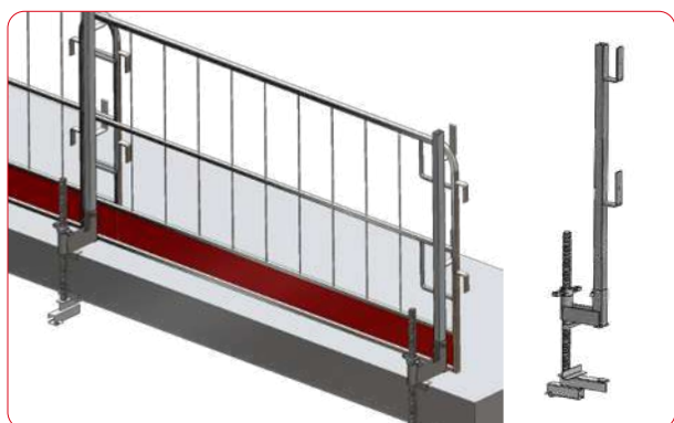
- Z UNI spono za steber varnostne ograje na robu plošče - Območje nastavitve: 5–45 cm
