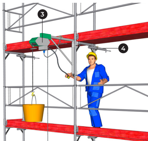
Aufbau mit elektrischer Winde
