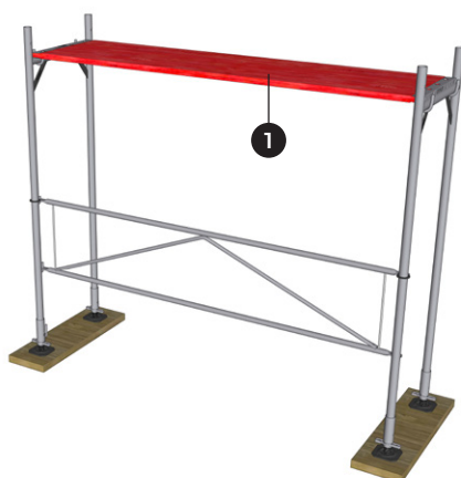
Fertigstellung des ersten Gerüstfeldes
